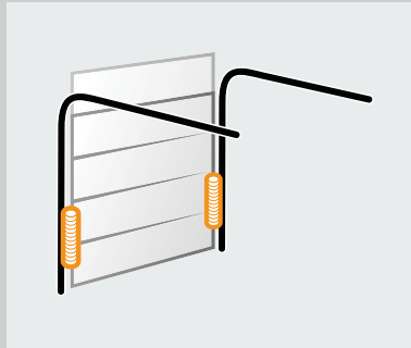
BZ-Beschlag: Zugfeder-Beschlag mit Zugfeder-Technik und flächenbündiger Blende
